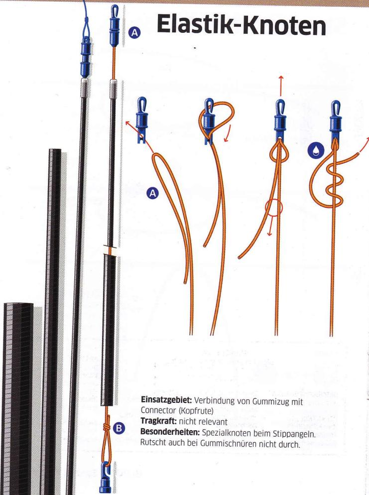
**Einsatzgebiet:** Verbindung von Gummizug mit Connector (Kopfrute)
