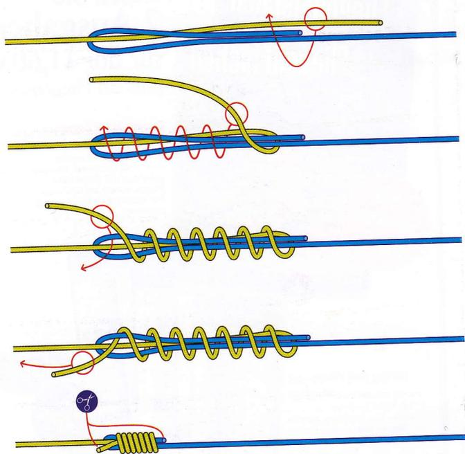
**Einsatzgebiet:** Verbindung von geflochtener Hauptschnur mit (Fluorocarbon-) Vorfach, Schlagschnur (Feedern, Brandungsangeln)
